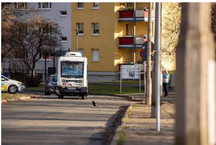
Bild 02: Mit 15 km/h fährt EMMA durch Lusan. Das Besondere: mit dem selbstfahrenden Kleinbus wird die letzte Meile geschlossen zwischen Tramstation, Einkaufszentrum und Wohnblock. Vor allem für ältere Mieter ein wichtiger Service. Foto: Thomas Müller
